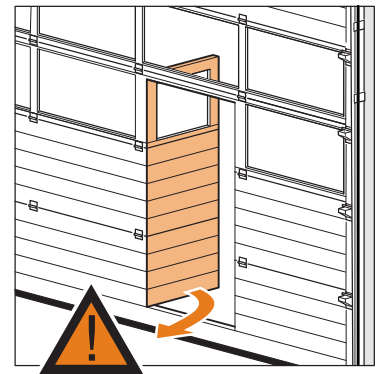
Vor Öffnen des Tores unbedingt sicherstellen, daß die Schlupftür geschlossen ist.
